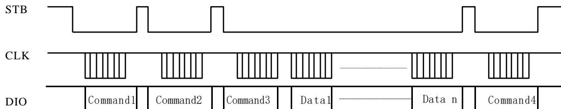
**Command1:** 设置显示模式。显示模式的设置在上电后设置，一般只需要设置一次就可以了。
