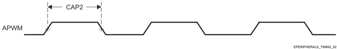
图 7-45. eCAP Output Timings
