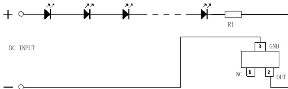
注:根据设计需要也可以在 OUT 端串接 R1 电阻用于分担芯片 OUT 端电压,以保证芯片功耗在可接受范围内。
